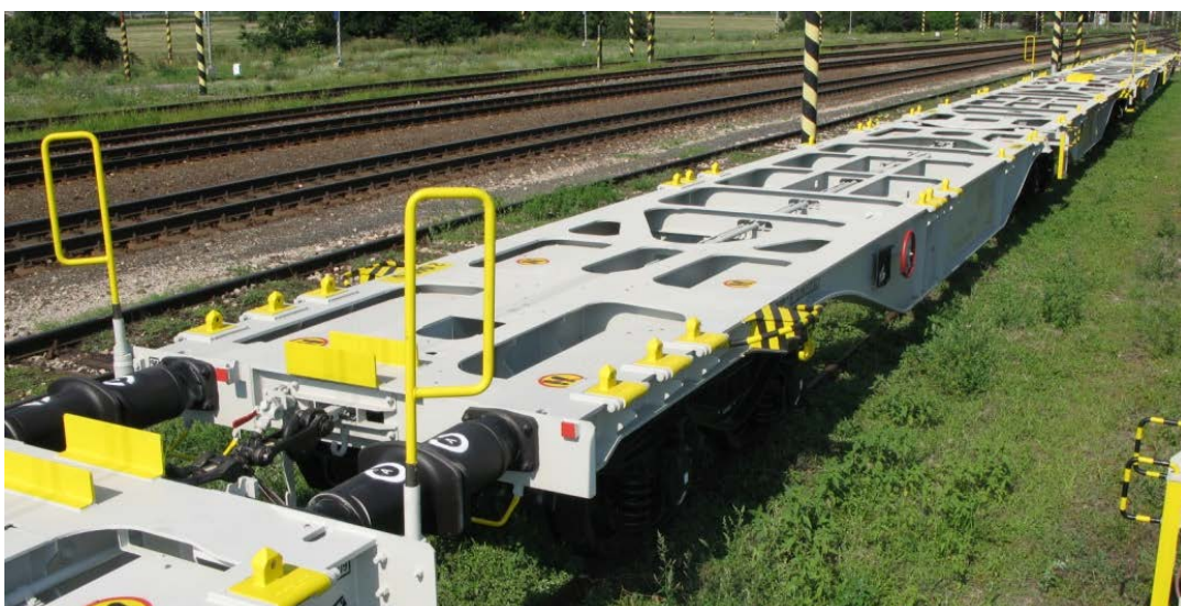
Obrázek 26 Kloubový železniční vůz Sggmrss 90 na přepravu dvojice 40 nebo 45stopých kontejnerů (Čermák, 2018)
