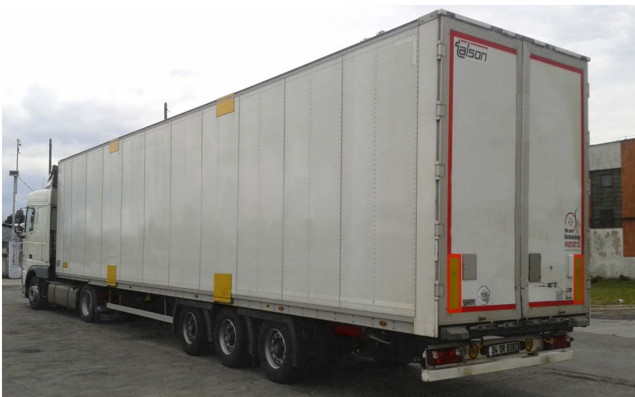
Obrázek 5 Skříňový High-Cube návěs pro multimodální přepravu s profilovým kódem P400, výškou točnice kapsového vozu 88 cm vhodný pro kapsové vozy e, f, g, i s pevností stěn EN 12642 XL (Čermák, 2018)
