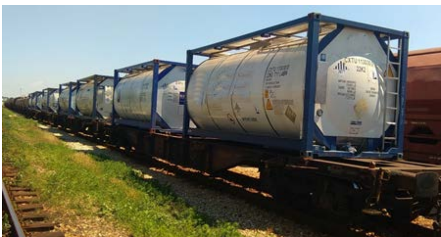
Obrázek 13 Skupina vozů Sgnss s cisternovými kontejnery 22K2 (kód cisterny ADR/RID L4BN, ADR/RID/IMDG instrukce pro přenosnou cisternu UN T11) (Čermák, 2018)
