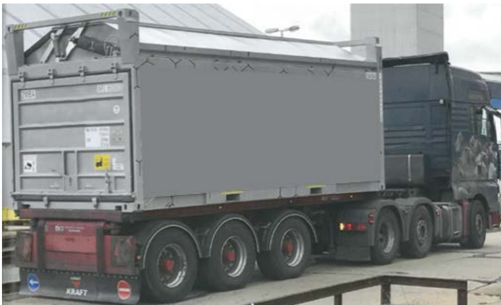
Obrázek 25 20stopý kontejner 2MBA s profilovým kódem C22 s celkovou hmotností 36 000 kg společnosti InnoFreight pro přepravu syvkých chemikálií (Čermák, 2018; InnoFreight, 2018)
