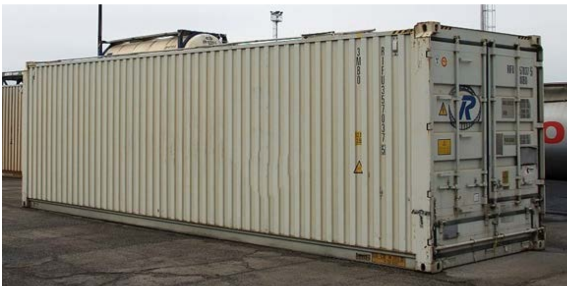
Obrázek 22 Bulk kontejner 30stopý 3MB0 pro přepravu granulátu (Čermák, 2018)
