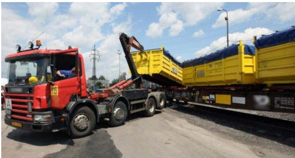
Obrázek 23 Překládka kontejneru ACTS z železničního vozu na silniční vozidlo (AWT, 2018)
