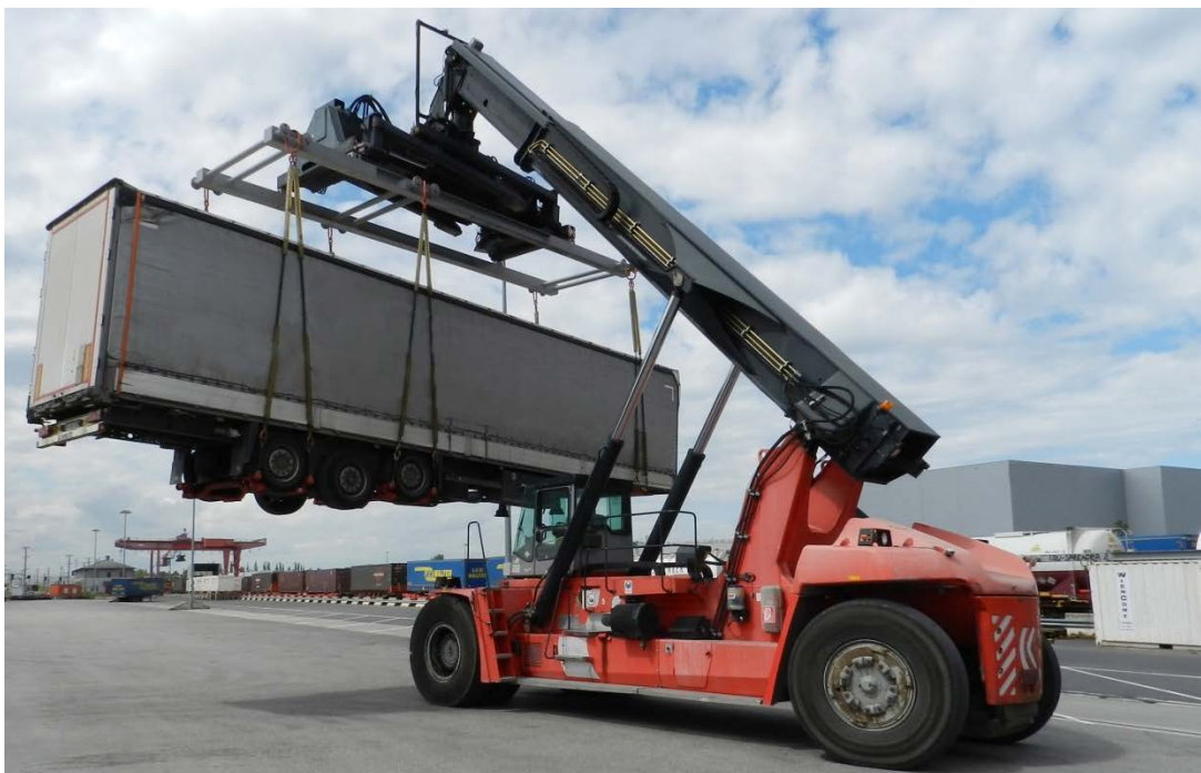
Obrázek 17 Překládka běžného návěsu čelním vozíkem (reachstackerem) pomocí ISU systému (Čermák, 2018)
