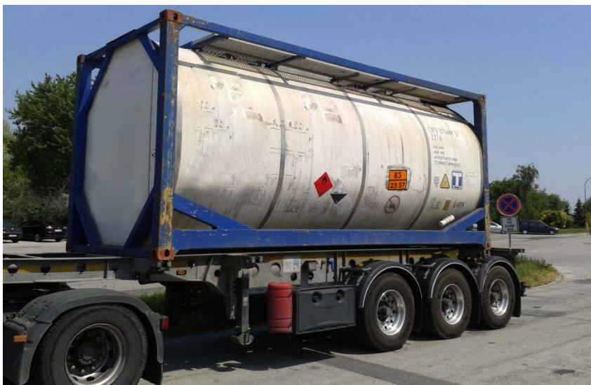
Obrázek 10 Návěs s 20stopým ISO kontejnerem 22T6/22K2 (kód cisterny ADR/RID L4BN, ADR/RID/IMDG instrukce pro přenosnou cisternu UN T11) (Čermák, 2018)
