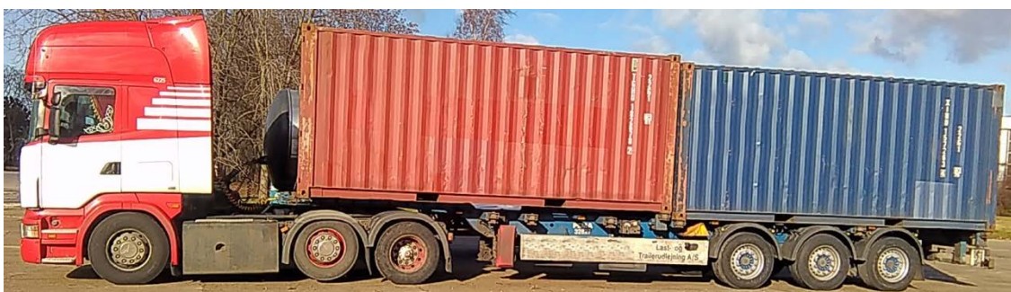
Obrázek 3 Návěs se dvěma 20stopými ISO kontejnery (22G1) (Čermák, 2018)
