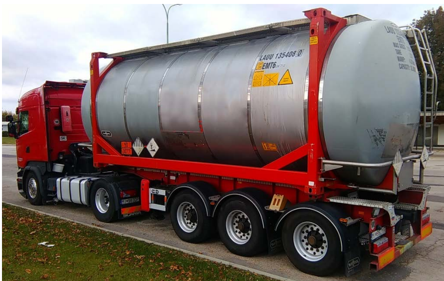
Obrázek 11 Cisternový kontejner EMT6/EMKD (kód cisterny ADR/RID L4BN, ADR/RID/IMDG instrukce pro přenosnou cisternu UN T12) o objemu 30 000 l (Čermák, 2018)
