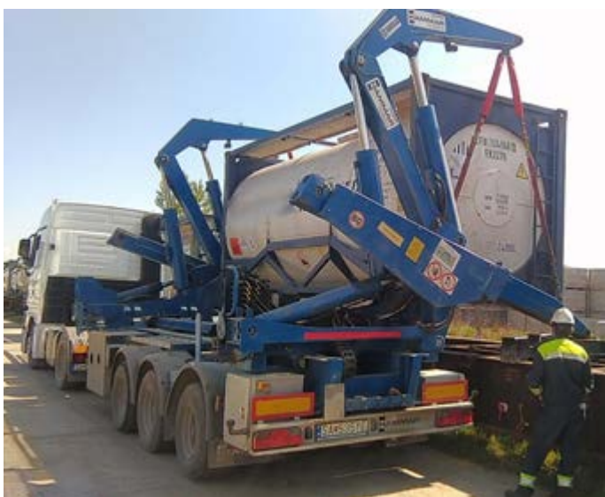
Obrázek 15 Překládka 20stopého cisternového kontejneru 22T6/22K2 z železničního vozu Sgns na návěs Hammar (Čermák, 2018)
