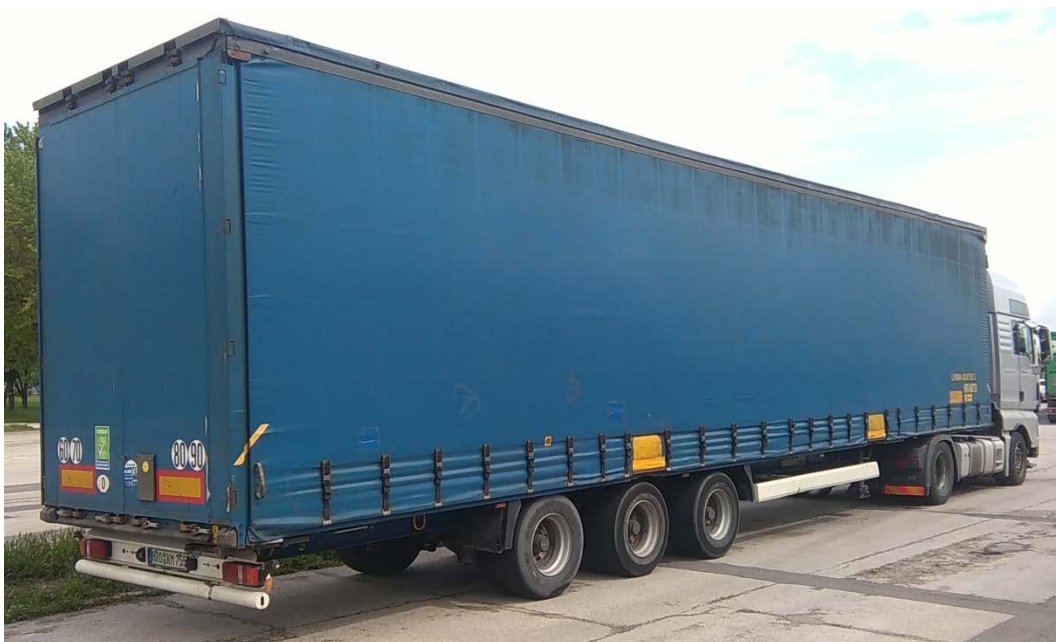
Obrázek 2 Intermodální návěs s profilovým kódem P400 s dvěma výškami točnice kapsového vozu 98 cm a 113 cm s pevností stěn EN 12642 XL (Jagelčák, 2018)
