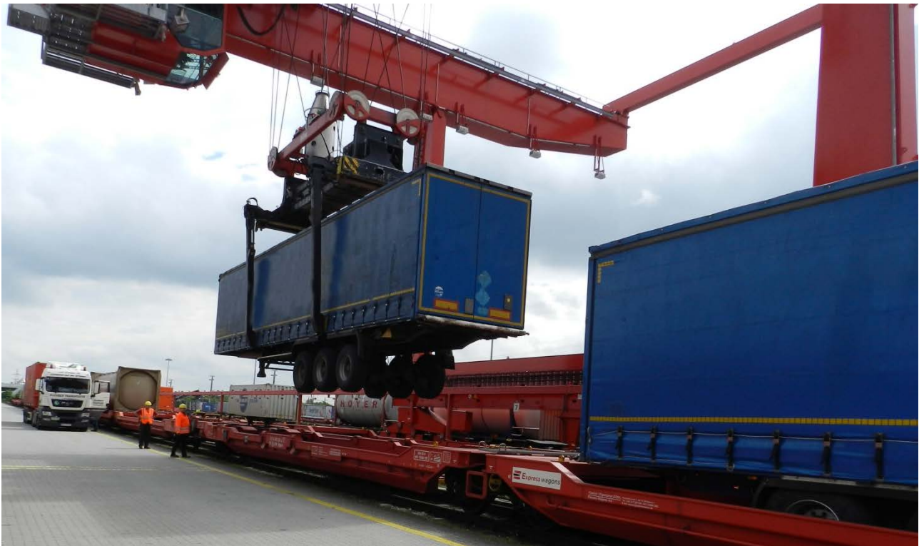
Obrázek 16 Překládka návěsů portálovým jeřábem (Čermák, 2018)
