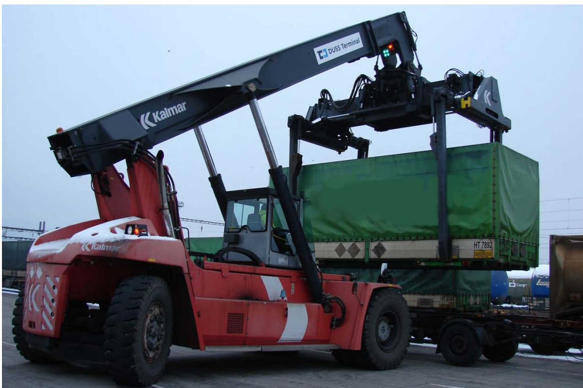
Obrázek 18 Překládka výměnných nástaveb C745 s profilovým kódem C45 čelním vozíkem (reachstackerem) (Čermák, 2018)
