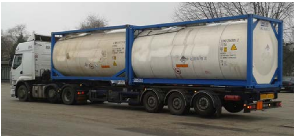
Obrázek 21 Návěs s dvojicí 20stopých cisternových kontejnerů 22T6/22K2 (instrukce pro přenosnou cisternu UN T11) (Čermák, 2018)
