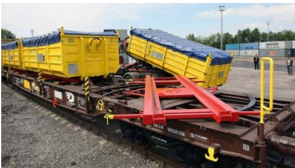
Obrázek 24 Železniční vůz Slps s pootočeným rámem ACTS kontejneru (AWT, 2018)
