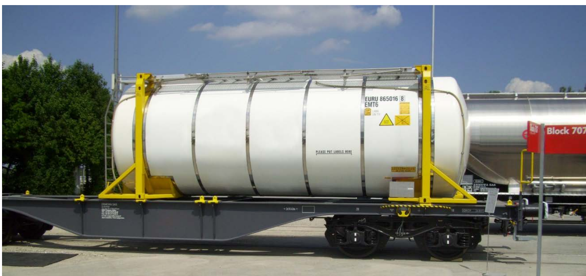
Obrázek 12 Cisternový kontejner EMT6/EMKD (kód cisterny ADR/RID L4BN, ADR/RID/IMDG instrukce pro přenosnou cisternu UN T11) vhodný pro kontinentální i příbřežní multimodální přepravy (Čermák, 2018)
