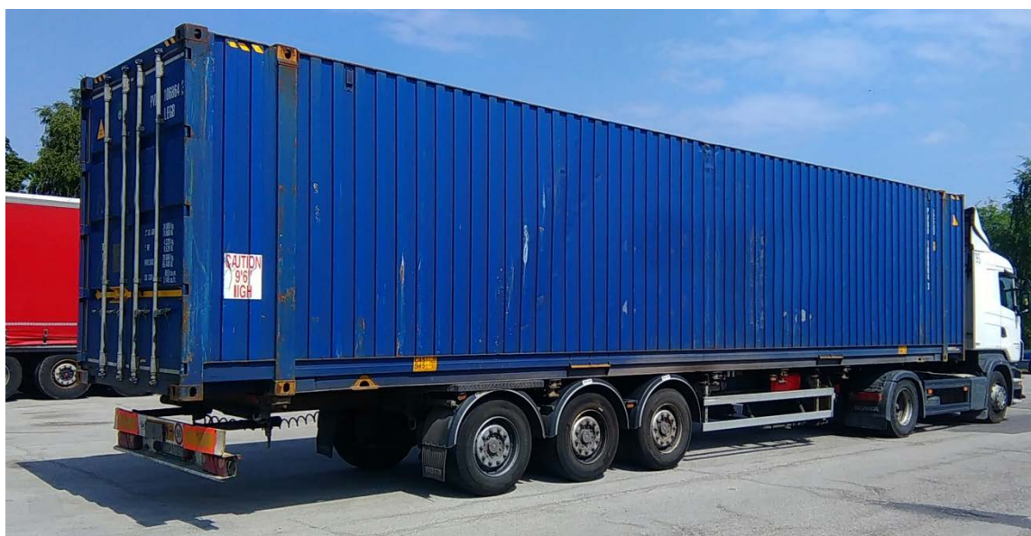
Obrázek 1 45stopý High-cube kontejner LEG1/LEGB (Čermák, 2018)
