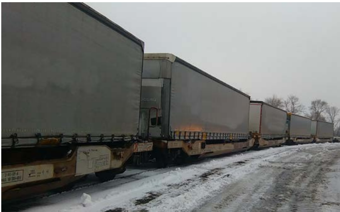
Obrázek 6 Vlak s naloženými High-Cube návěsy s profilovým kódem P400, výškou točnice kapsového vozu 88 cm vhodný pro kapsové vozy e, f, g s pevností stěn EN 12642 XL v kapsových vozech Sdggmrs (C a P typ g - výška točnice 88 cm, 98 cm, 113 cm) (Čermák, 2018)
