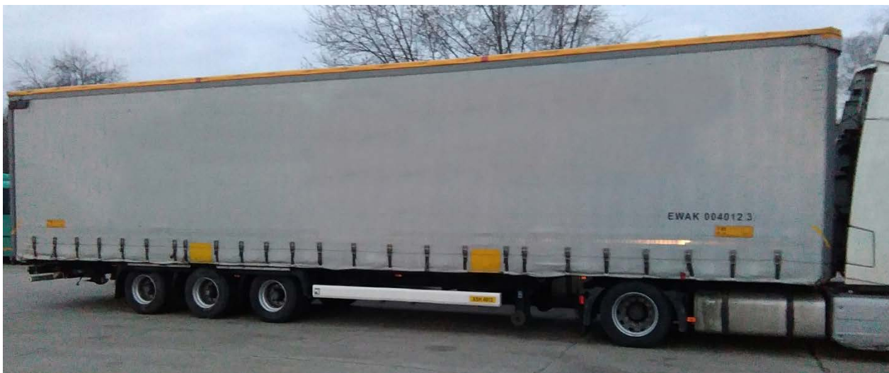
Obrázek 4 Multimodální High-cube návěs s profilovým kódem P400, výškou točnice kapsového vozu 88 cm vhodný pro kapsové vozy e, f, g, i s pevností stěn EN 12642 XL (Čermák, 2018)
