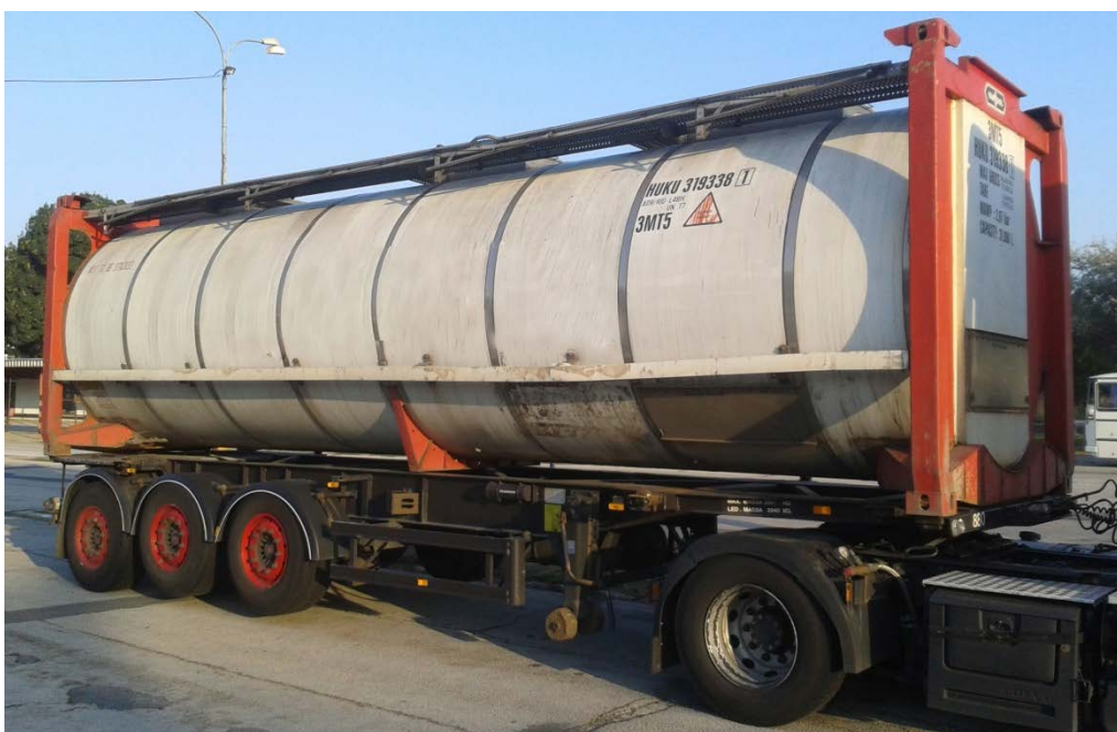
Obrázek 7 Cisternový 30stopý kontejner 3MT5/3MKD (kód cisterny ADR/RID L4BH, ADR/RID/IMDG instrukce pro přenosnou cisternu UN T7) (Čermák, 2018)
